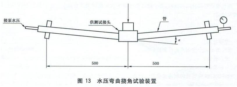
图 13 水压弯曲挠角试验装置
